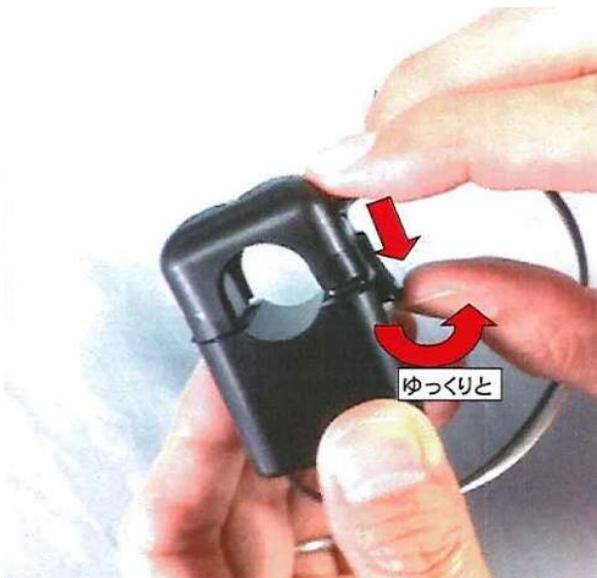
②上部突起部を押し下げながらフックをゆっくりと持ち上げて凸部から開放する。フックを瞬間的に曲げるとフックが折れることがあります。
