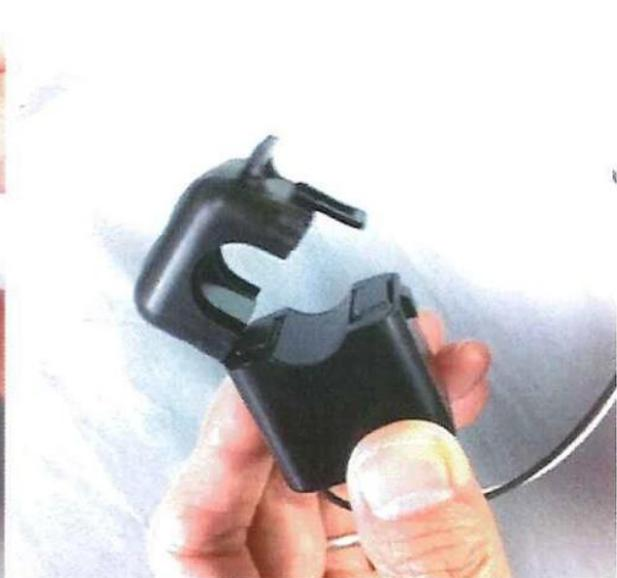
③完全に開いたら被測定ケーブルの挟み込み可能な位置までクランプ式センサを移動させます。
