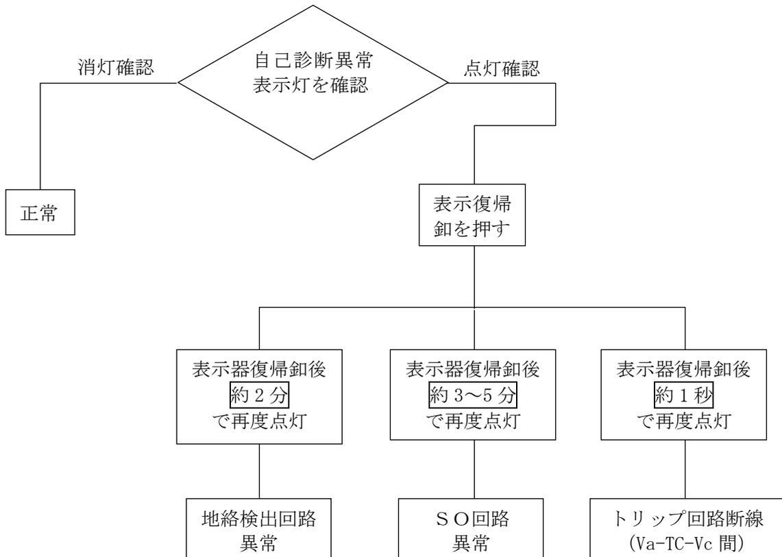
※1. 制御電源が常時印加されている状態で、制御線 Va, Vc を外すと自己診断異常表示灯が点灯しますが、異常ではありません。
