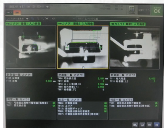
接点面の異物検査
