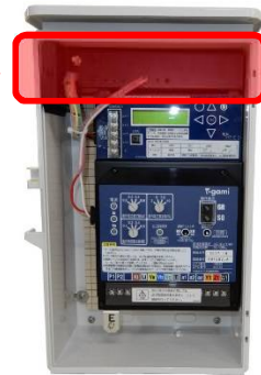
地絡波形収集装置を組み込んだ 制御装置 (CHZ 形)
